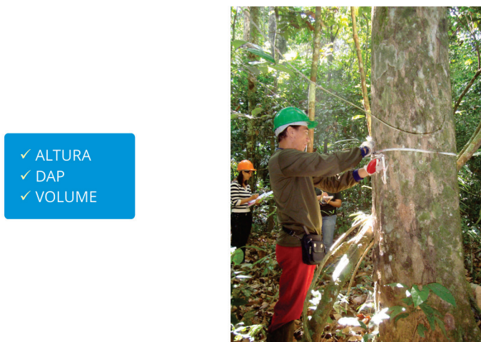
Figura 21 - Medição do diâmetro a 1,30m do solo.
